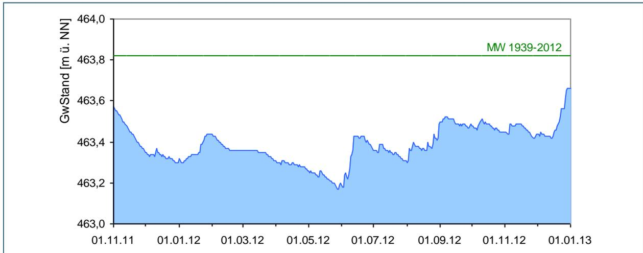
Abb. 32: Verlauf der Grundwasserstände im Niederterrassenschotter der Münchener Schotterebene (Messstelle Eching 275D, beobachtet seit 1939) - HHW: 465,59 m ü. NN, MW: 463,82 m ü. NN, NNW: 462,68 m ü. NN
